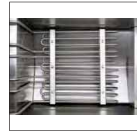
Résistance, brides et cache-filtrant / Heating element, flanges and filtering cover
